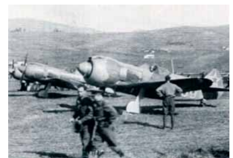
Lawotschkin La-5 mit einem Doppelsternmotor ASch-82. Leistung 1350 PS.
