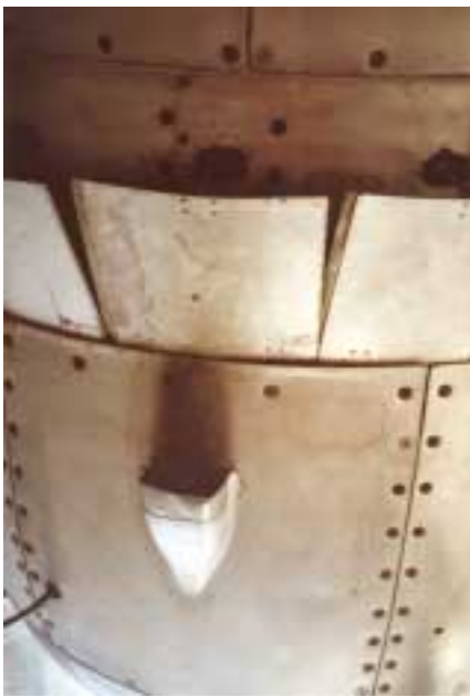
Die charakteristischen Auspuffhutzen an der Motorenverkleidung und Kühlklappen
